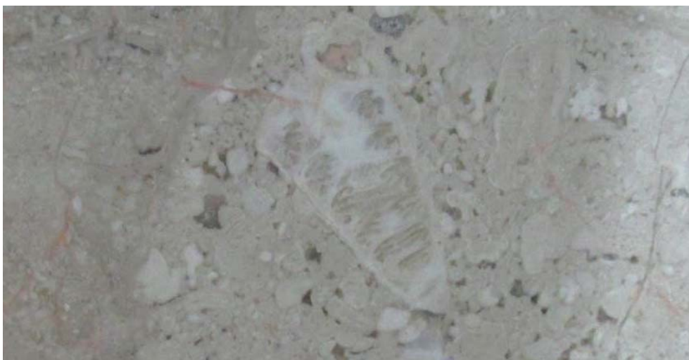
Slika 5. Presjek fosilnog puža iz skupine nerineida (rod Plesioptygmatis ) na kamenoj ploči AG-kamena tipa Rujan postavljenoj na unutarnje stepenište jednog hercegovačkog objekta.
