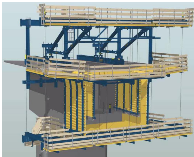
Slika 19. Skela i oplata za slobodnu konzolnu gradnju
