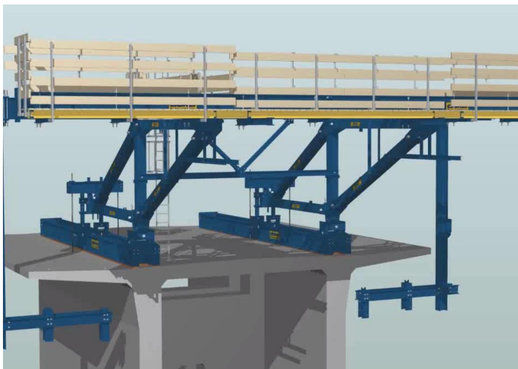
Slika 18. Monta0a oplata i skele za slobodnu konzolnu gradnju
