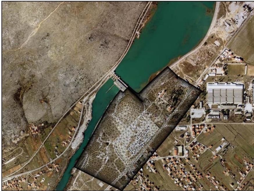
Slika 4. Mreža trokutnih konačnih elemenata na tlocrtnom modelu područja HEMO
