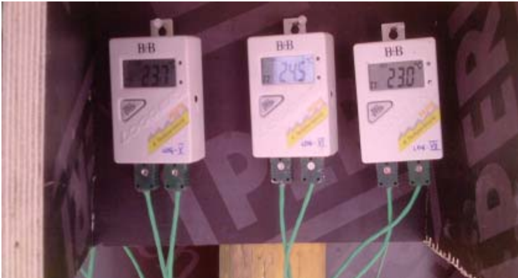
Slika 13. Mjerenje temperature svježeg betona
