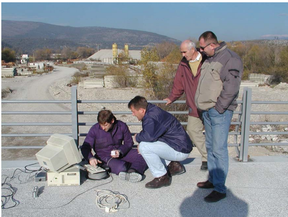
Slika 16. Mjerenje ubrzanja pri dinamičkom ispitivanju mosta
