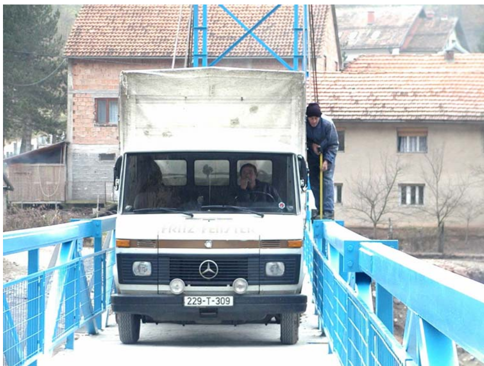
Slika 20. Mjerenje ugiba pri ispitivanju mosta
