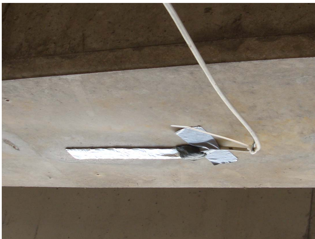
Slika 4. Mjerna traka za beton
