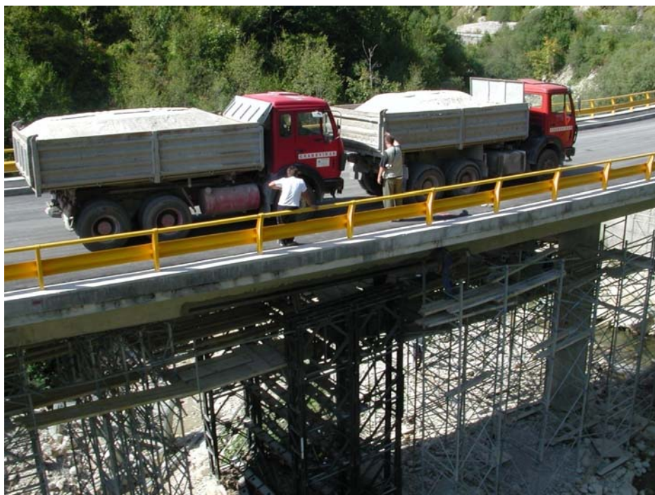
Slika 18. Postavljanje vozila za opterećenje u drugom polju mosta
