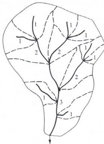
Slika 4. Ilustracija slivnog područja sa vodotokom najvećeg reda tri prema Strahlerovoj shemi rangiranja riječnih tokova prema redovima, [Rodríguez-Iturbe, 1979.]
