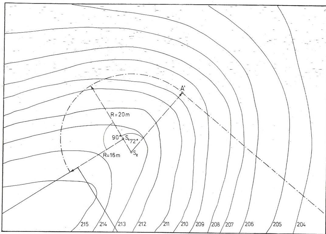
18. Od horizontalnog platoa (kota 206) odvajaju se horizontalna cesta s 3m, te željeznička pruga s 4m širokim planumom. Željeznička pruga je do točke A horizontalna, a od A prema B ima uspon 6%.
