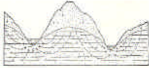
Sl. 72. Cjelokupljeni krugisanje podzemne vode u homogenom propusnom sloju (po M. King Heisterud)
