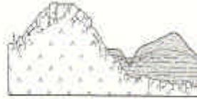
Sl. 73. Podzemna voda u poroznima meduljnim tijelima i u granularnim analogima
